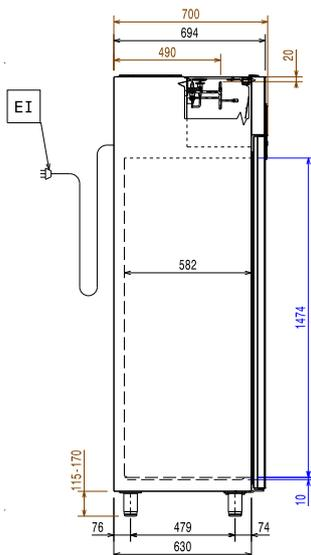
EI = Conexión eléctrica (energía)
